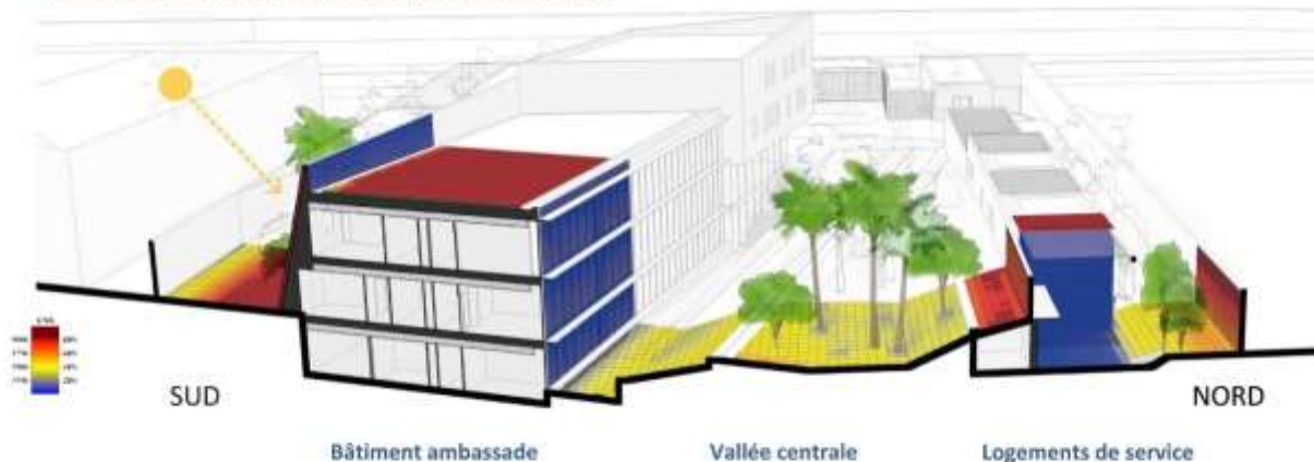
Simulation d'ensoleillement des façades et toitures sur une année complète
